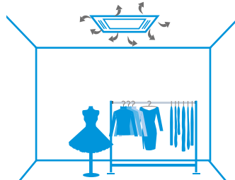
Luftverteilung bei verstaubtem Filter
